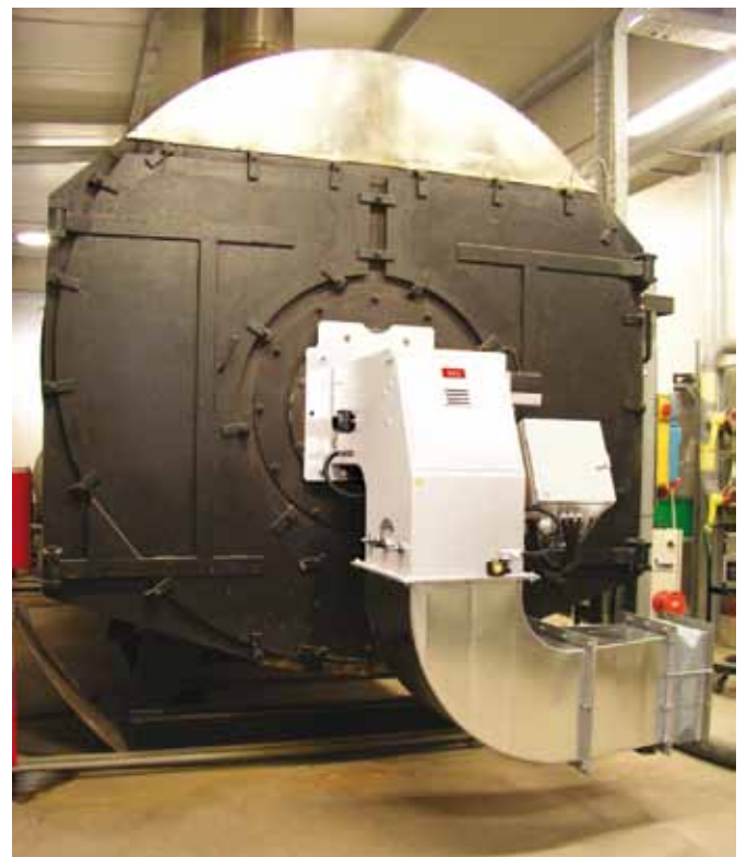
Laboratoire de Resana pour les tests des brûleurs à forte puissance
