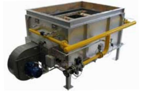
Die „HGC“ Gebläse-Generatorlinie wird in all jenen Anwendungen eingesetzt, bei denen während des industriellen Prozesses eine direkte Lufterhitzung erforderlich ist. Die Baugruppe besteht aus einem Rohrabschnitt mit Materialien, die gegen hohe Temperaturen und/oder die behandelte Flüssigkeit beständig sind, einem „DBC“-Brenner, der entsprechend dimensioniert und montiert ist, um den optimalen Austausch zwischen verbranntem Gas und Prozessluft zu ermöglichen.
