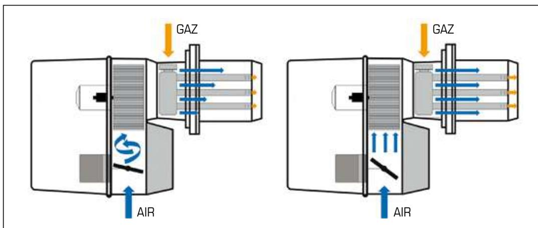
**Fig. 1** - Exemple de comportement du ventilateur d'un brûleur lorsque la puissance est réduite à moins de 20%. À gauche, les instabilités du débit d'air avec un excès d'air normal de 15-20%. À droite, l'élimination du phénomène en augmentant l'excès d'air à 50% et plus
