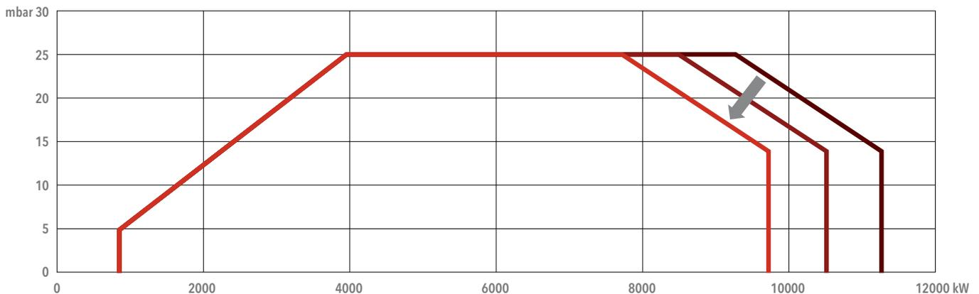
Le résultat est que la courbe de fonctionnement du brûleur est réduit proportionnellement à la quantité de la recirculation.
