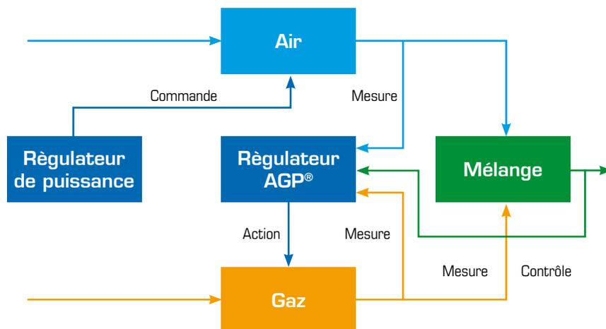
Le régulateur agit sur le gaz en fonction de la mesure des pression. Le mélange est contrôlé en permanence.
