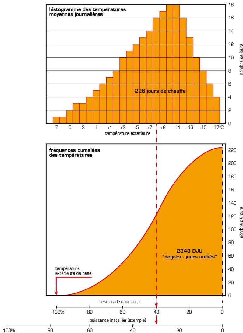
On constate que l'installation de chauffage va fonctionner la plus grande partie du temps avec un faible taux de marche, phénomène accentué par la surpuissance mise en jeu.
