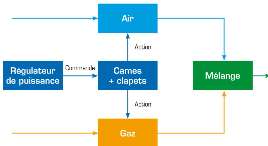
Le dispositif de cames et de clapets agit sur l'air et le gaz suivant un pré-réglage. Le mélange n'est pas contrôlé.
