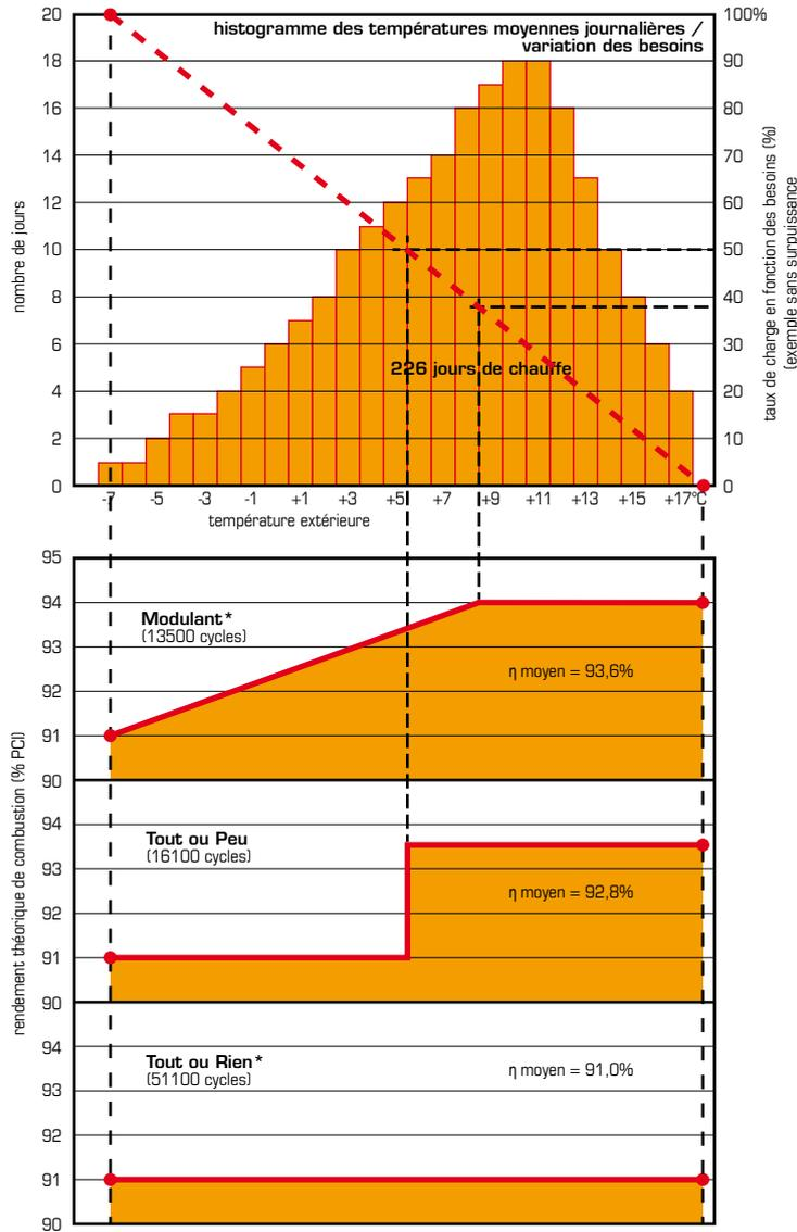
\* **Nota:** les variations de rendement et la charge minimale sont aussi fonction du type et du modèle de chaudière (voir documentation des constructeurs).
