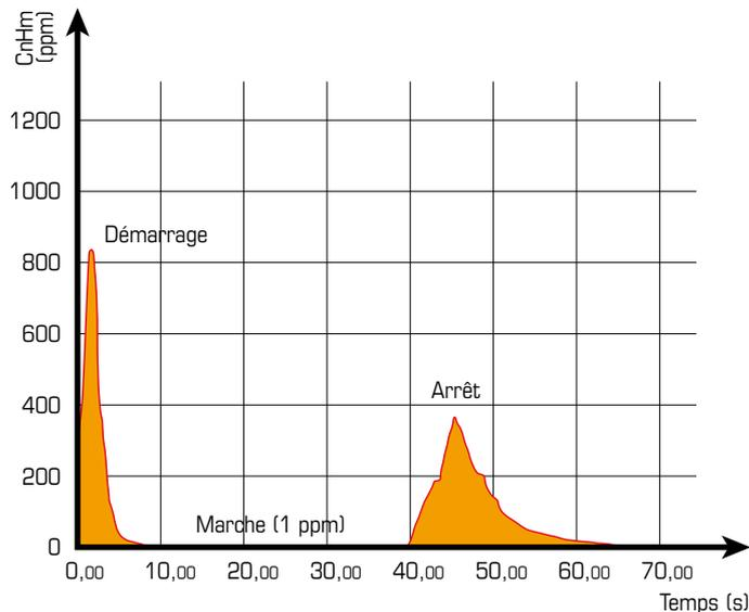
Les deux surfaces: Démarrage + Arrêt sont équivalentes à un fonctionnement en pleine allure de **1 heure et 20 minutes**.
