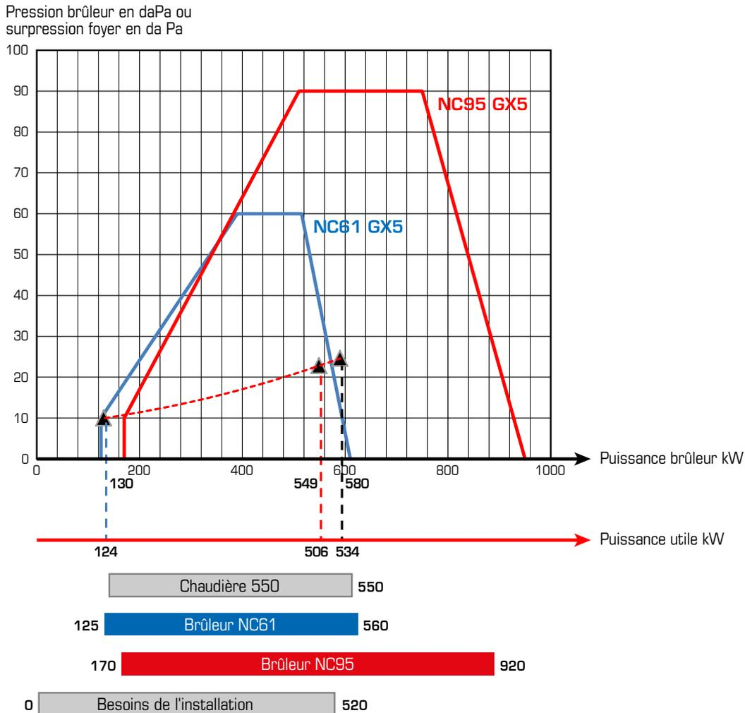
Pour notre exemple le brûleur le mieux adaptés aux besoins maximum de l'installation (520 kW) et permettant de fournir le minimum de la chaudière (124 kW) est le NC61.
