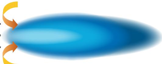
Una volta gassificato, il gasolio si infiamma e si stabilizza ad una distanza di circa 30 centimetri dalla testa di combustione.
