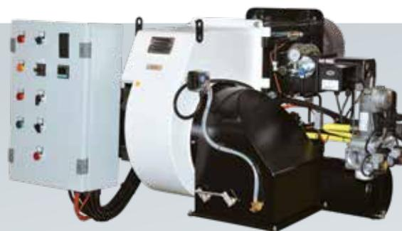
ELCO- Zweistoffbrenner GHO-TRON sind für den Betrieb mit Erdgas und Schweröl bis zu einer Viskosität von 50°E bei 50°C ausgelegt. Die Betriebsweise ist zweistufig (bis GHO-TRON 3) oder zweistufig modulierend mit mechanischer Verbundregelung zur präzisen Einstellung des Brennstoff- Luftverhältnis (bis 17MW). Weitere Ausführungsvarianten für Sonderbrennstoffe oder für spezielle Anlagenanforderungen stehen auf Anfrage zur Verfügung.
