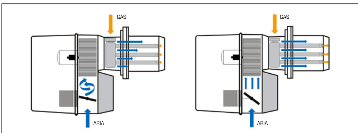
**Fig. 1** - Esempio di comportamento del ventilatore di un bruciatore quando la potenza viene ridotta a meno del 20%. A sinistra, le instabilità nella portata d'aria con un normale eccesso d'aria del 15-20%. A destra, l'eliminazione del fenomeno aumentando l'eccesso d'aria al 50% e oltre.
