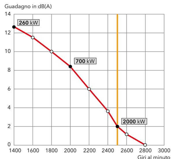
Fig. 3 - Attenuazione sonora mediamente ottenibile con l'inverter nel campo di lavoro del bruciatore.
