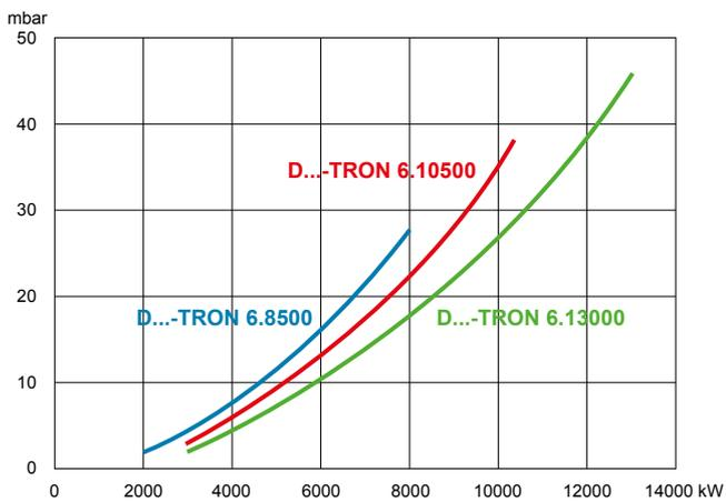
Gasseitiger Druckverlust des Brennkopfes
